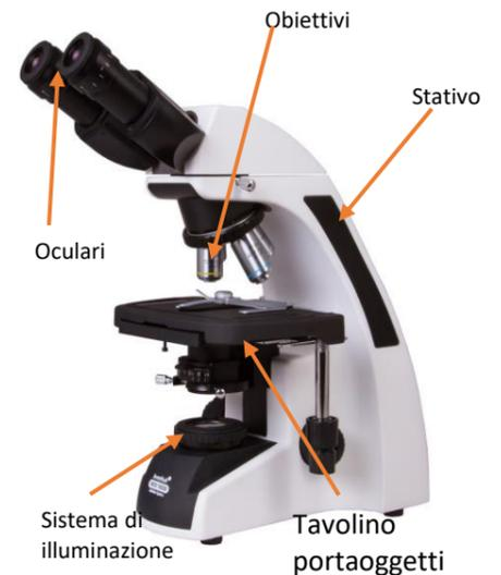
IL POTERE DI INGRANDIMENTO di un microscopio ottico può essere potenziato fino a 2000 volte, invece non è possibile aumentare IL POTERE DI RISOLUZIONE, cioè la capacità dello strumento di mettere a fuoco l'immagine. Questo accade perché il microscopio ottico sfrutta le onde che formano la luce, le quali possiedono certe caratteristiche. Vi immaginate che un oggetto simile permettesse di vedere una cosa piccolissima come una cellula?
